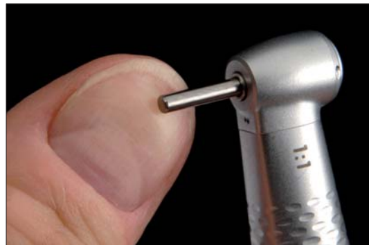
Prüfung mit Prüfinstrumenten in Rotation - Schäden zeigen sich durch Vibrationen. Rotary check with test instruments – damage is indicated by vibrations. Contrôle en rotation à l'aide d'éprouvettes d'instruments – les endommagements se signalent par des vibrations.
