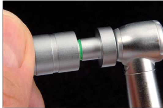
Prüfung mit einem Haltekraftprüfer. Check with a retention force tester. Vérification à l'aide d'une jauge de forces.
